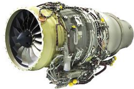
GEと共同開発のHF120エンジン HPより
