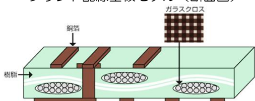
プリント配線基板モデル（断面図）
